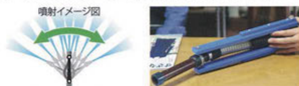
噴射の勢いでトグル機構が作動し、もともとの用途は海賊撃退の放水ノズルが左右に振れる。
