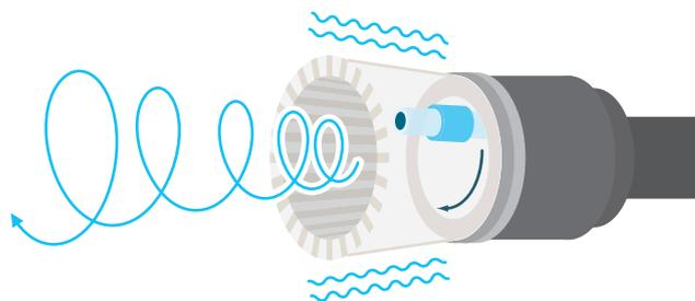
内部の回転チューブエアーが、ブラシを細かく振動(イメージ図)
