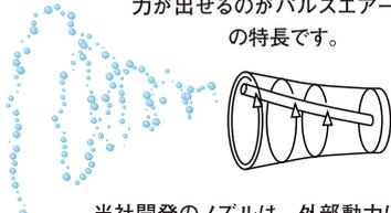
当社開発のノズルは、外部動力に頼らず特殊チューブにより前に出る力の反作用で回転する力（遠心力）を実現させました。
