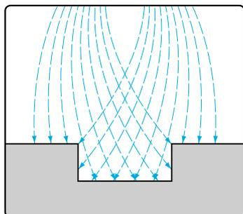
微細な水粒子がパルスエアと超音波の力で、対象物の窪み・溝などの隙間の汚れも落とします。
